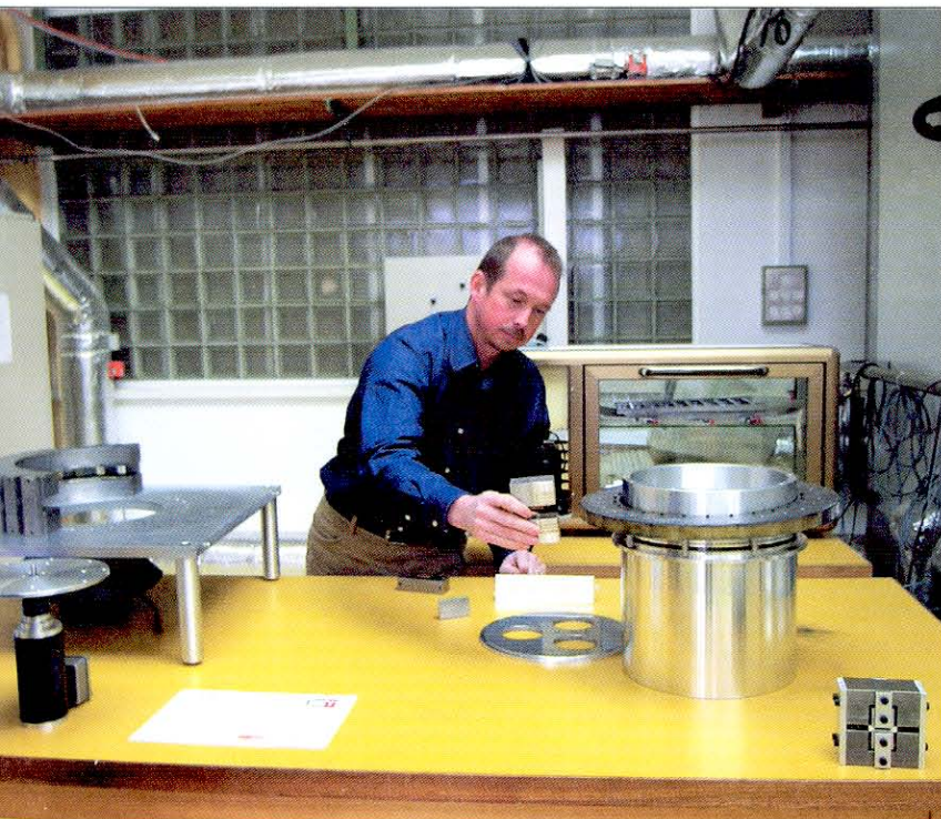
Stand d'essais de réfrigération magnétocalorique au laboratoire de l'Institut de Génie Thermique de la HEIG-VD. L'échangeur thermique tourne dans un champ magnétique et refroidit ou chauffe l'air.
